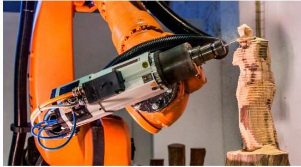
Figura 3- Exemplo de método subtrativo por uma fresadora
