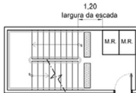
Figura 29: Escada de emergência com área de posicionamento de pessoas com cadeira de rodas.
